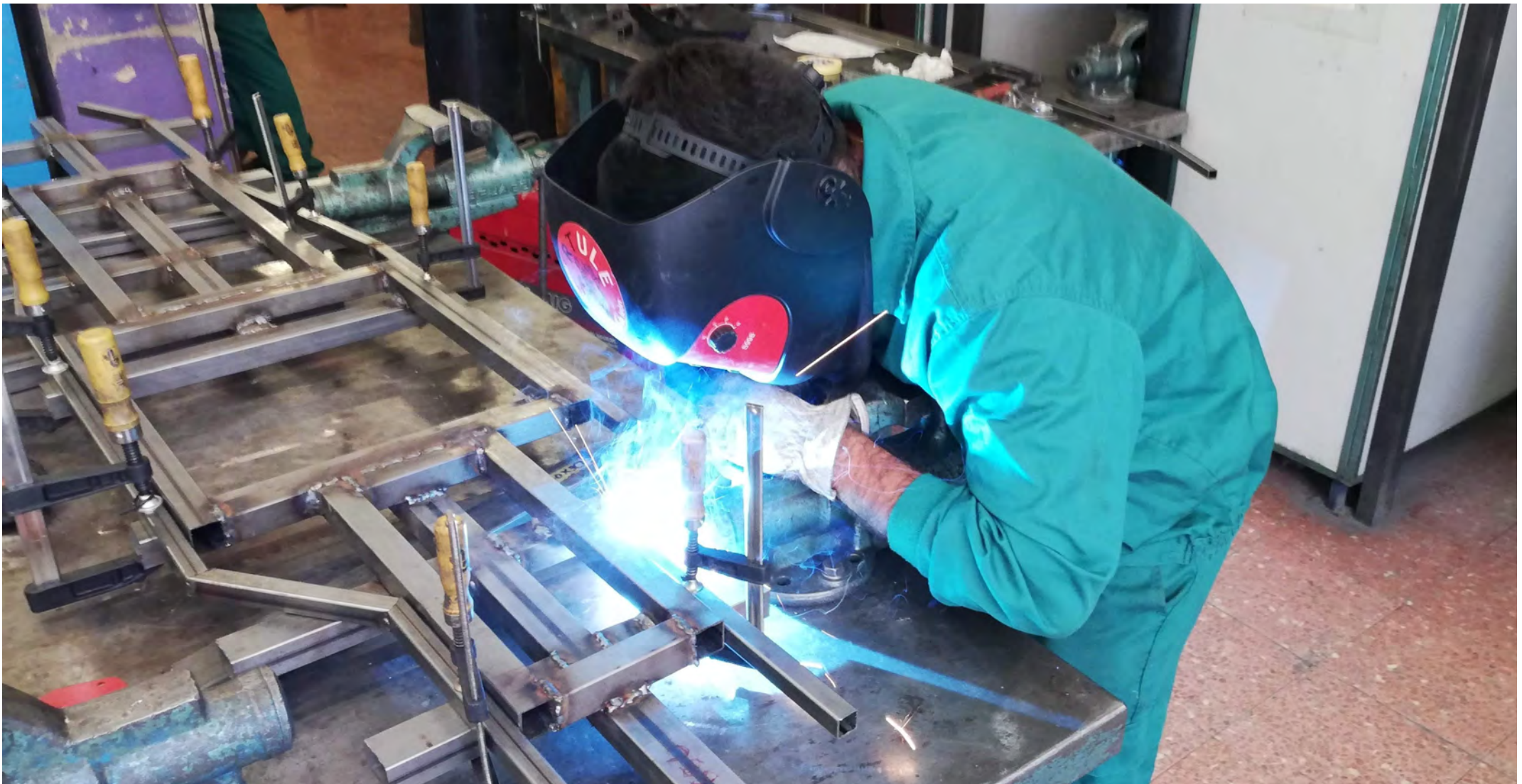
Figura 8: Soldadura del utillaje para la fabricación del chasis. IES Giner de los Ríos (León). Estudiante de Formación Profesional. 27 de agosto de 2019
