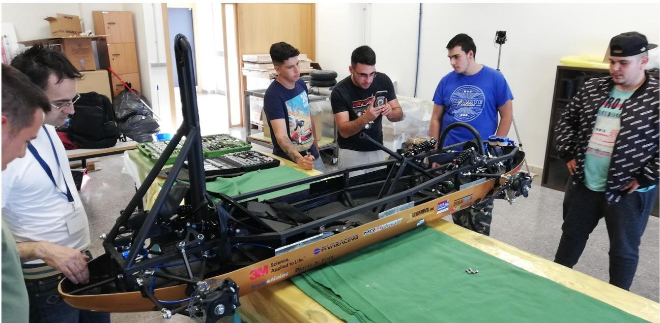
Foto 3: Prototipo RTULE Inercia2 el 13/9/2019. Alumnos de FP del IES Giner de los Ríos y de la Universidad de León realizando la configuración de los parámetros vectoriales.
